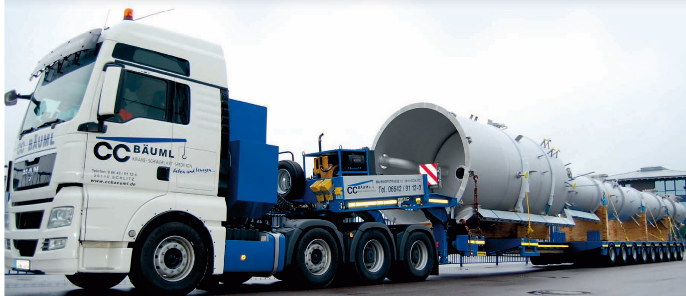
36 m langer Transport eines Kraftwerkanlagenteils nach Schwedt.
